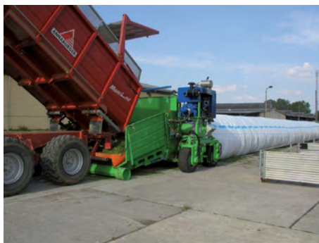
Рис. 14. Укладка и трамбовка с помощью прессы для пленочного рукава
